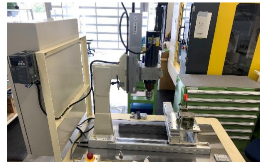
図 7. 完成した NC ボール盤
