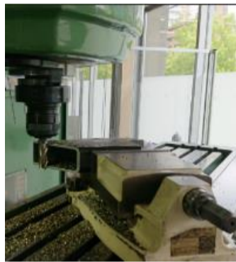
図 1. フレームの部材加工 → 図 2. フレームの溶接 → 図 3. フレームの歪み取り
