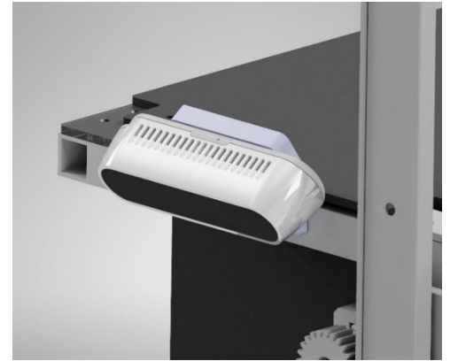
図4. 画像認識に使用したカメラ (intel RealSense™ Depth Camera D435)
