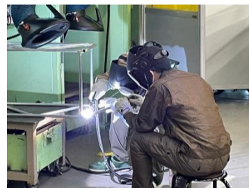
図 2. TIG 溶接作業
