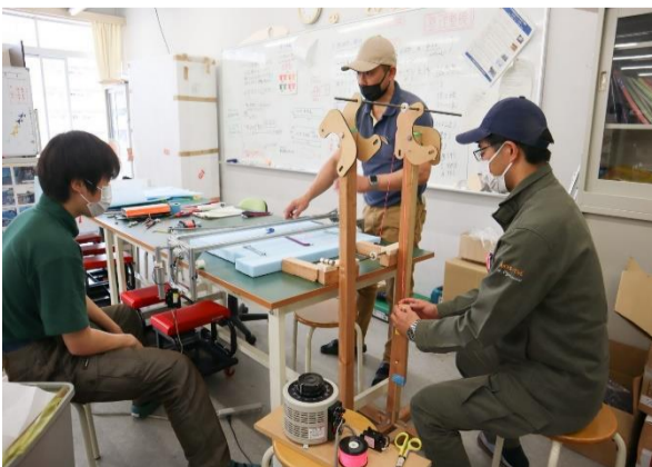
◀自作の機械で スタイロフォームを 厚み 2 mm に切り出す 作業
