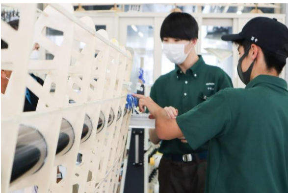
◀リブの取り付け後の確認作業
